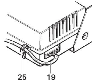
Jako reduktor napięcia zabezpieczający kabel elementu obsługi (19) wykorzystać załączoną opaskę (25), mocując kabel do urządzenia elektroniki sterowania.
