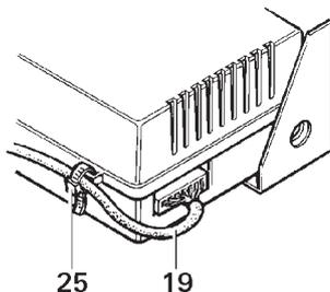
Kiinnitä käyttöosan kaapeli (19) ohjauselektroniikkaan mukana toimitettua vedonpoistimena toimivaa kaapelinjatkosta (25) käyttäen.
