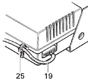
Per eliminare la trazione, fissare il cavo dell'unità di comando (19) al dispositivo elettronico di comando con il fermo fornito (25).
