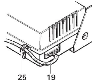
Som trækaflastning skal betjeningsdelens kabel (19) sikres på styreelektronikken med den vedlagte kabelbinder (25).
