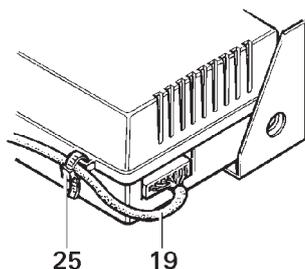
Säkra manöverdelskabeln (19) vid det elektroniska styraggregatet med den bifogade kabelbindningen (25) för att undvika dragbelastning.
