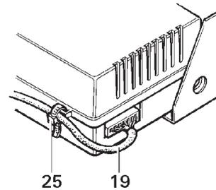
Als trekcontasting van de kabel van het bedieningselement (19) door middel van de ingesloten kabelbinder (25) aan de regelelektronica beveiligen.
