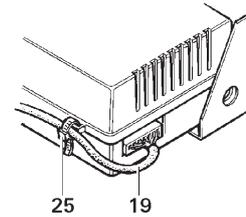
En tant que délestage de traction, attacher le câble de la pièce de commande (19) à l'aide du collier fourni (25) au niveau du système électronique de commande.
