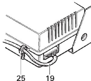
Pro odlehčení od tahu kabel ovládacího dílu (19) zajistěte přiloženým úchytným páskem (25) na řídicí elektronice.
