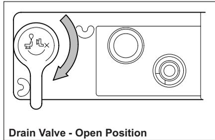
**Drain Valve - Open Position**
